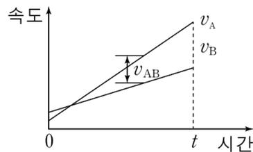
시간  $t$ 일 때, 각 물체의 변위는  $s_A = v_A t + \frac{a}{2} a_A t^2$ ,  $s_B = v_B t + \frac{a}{2} a_B t^2$ 이므로
