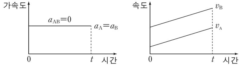
가속도가 같은 두 물체에 대하여,  $a_{AB} = 0$ 이므로 상대속도의 크기는 일정하고, 두 물체 사이의 거리의 변화량은  $\Delta L = v_{AB}t$ 이므로 시간에 대하여 일정하게 증가 혹은 감소하게 됩니다.
